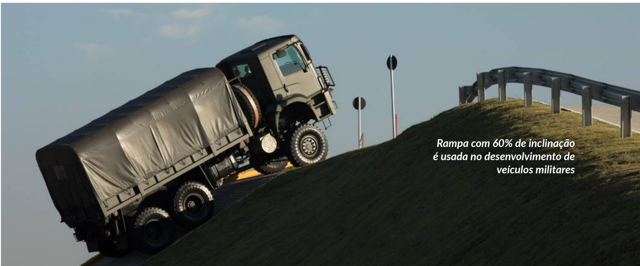
*Rampa com 60% de inclinação é usada no desenvolvimento de veículos militares*
