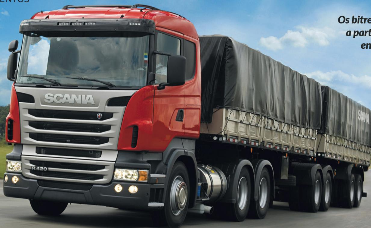
*Os bitrens de 7 eixos fabricados a partir de 2011 só podem ser engatados em cavalos 6x4*
